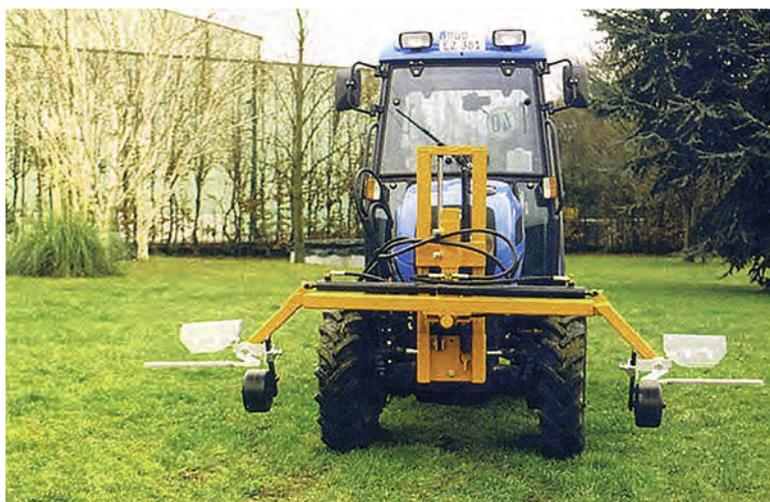
Anzubauen an die Schlepper-Fronthydraulik oder mitgelieferte Turmaushebung. Abtrifffreie und sparsame Spritzkästen mit Federfinger.
