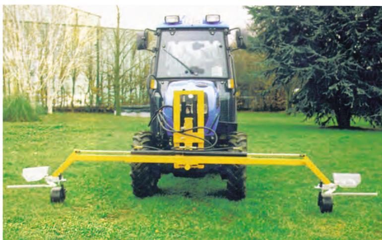
Herbizidspritzgerät mit Spritzhauben und Federfinger. Auf Wunsch mit Flachstrahl-Injektordüsen, Schmalstellung.
