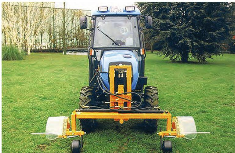
Herbizidspritzgerät mit hydraulischer Aushebung und Breitenverstellung für Reihen von 2.4 - 3.4 m. Gewünschte Sonderbreiten auf Anfrage!
